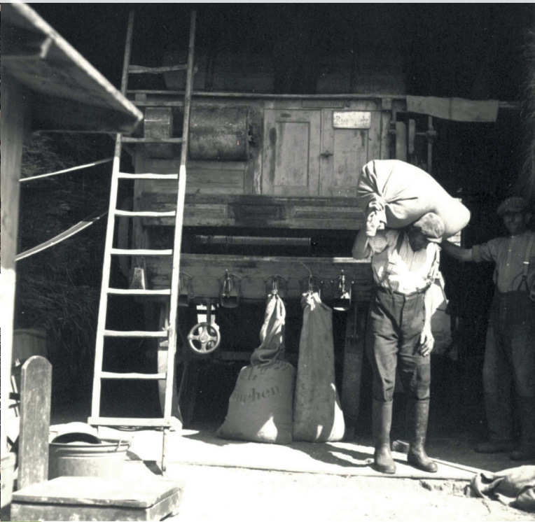
1938: Dreschmaschine: Das Korn wurde in Säcke gefüllt und auf dem Rücken auf den oberen Boden transportiert zum Lagern Privatarchiv Johann Eggerstorfer
