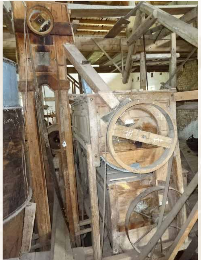
Der Doppeltrieb, ein Gerät das Reinigung des Getreides diente, stammte vermutlich aus den 1930er Jahren
