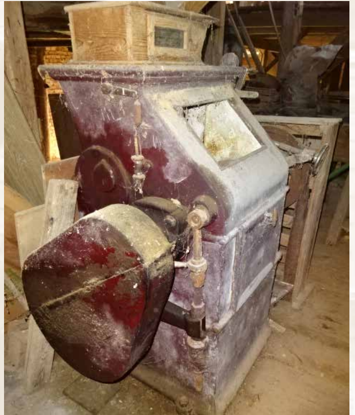
Der Walzenstuhl stammt vermutlich aus den 1930er Jahren
